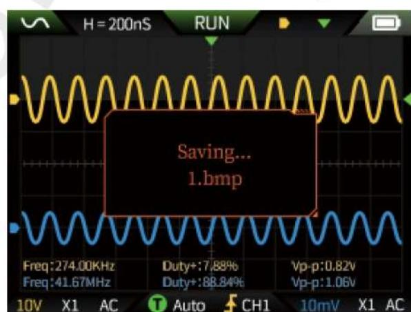
**② Zobrazit snímek obrazovky :** Dlouhým stisknutím tlačítka **SAVE** vstoupíte na stránku pro zobrazení uloženého snímku obrazovky. Stisknutím tlačítka **||▶** vstoupíte do rozhraní uloženého snímku obrazovky.
